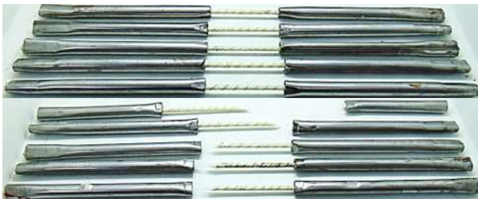
Figura 2: Corpos de prova antes e após ensaio de resistência à tração.
