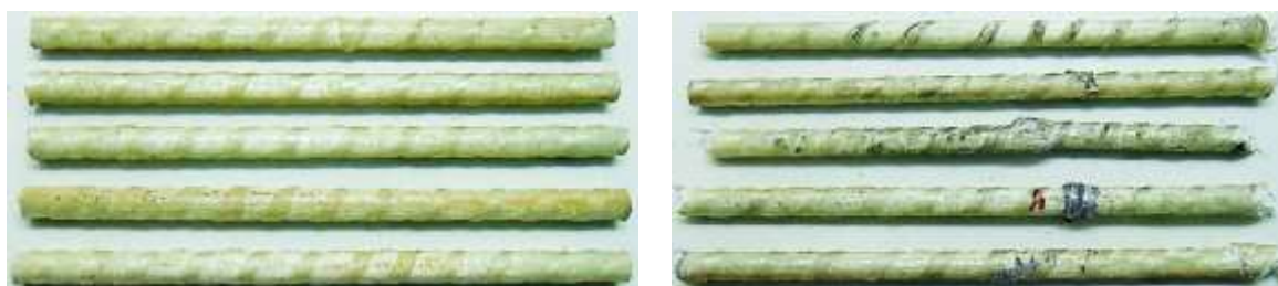
Figura 4: Corpos de prova antes e após ensaio de resistência à compressão axial.
